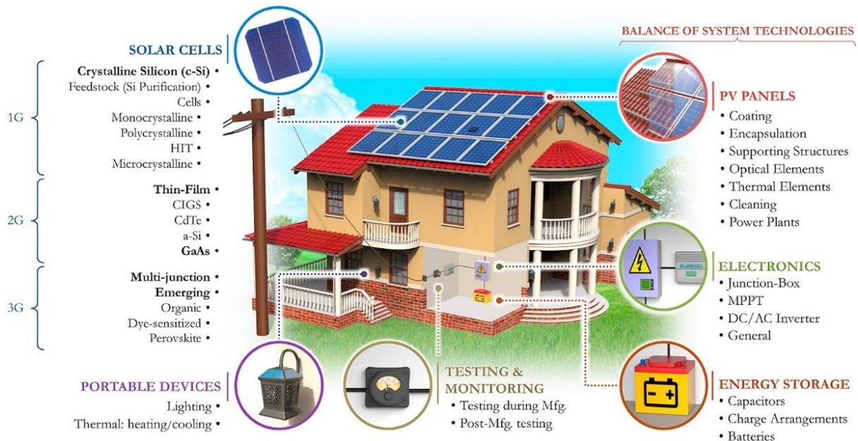
Slika 2.3. Komponente FN sustava i podjela FN tehnologija po generacijama
