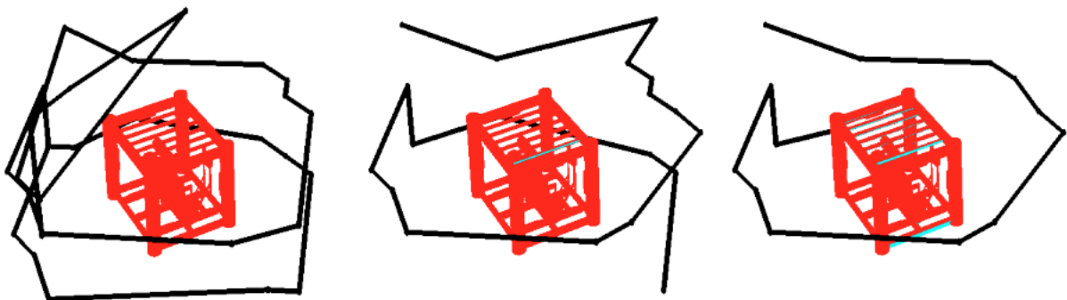
Slika: putanje isplanirane MOEA algoritmom sa različitim inicijalnim parametrima inspekcije. Struktura prikazana u crvenom, putanja u crnom.
